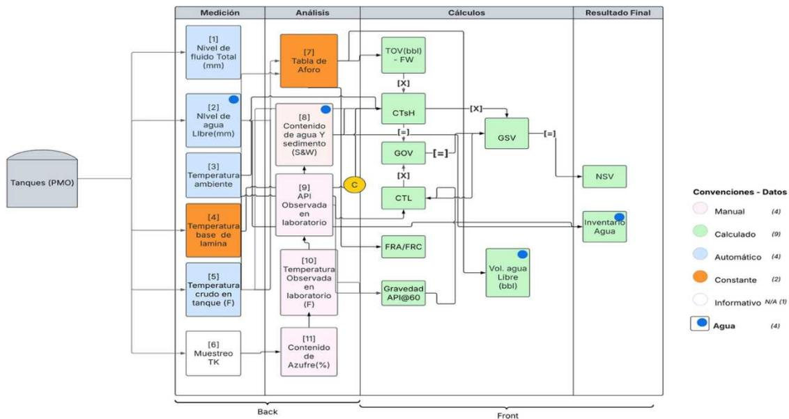
**Figura 1. Diagrama de variables del proceso de medición del IDP para tanques PMO de crudo.**
