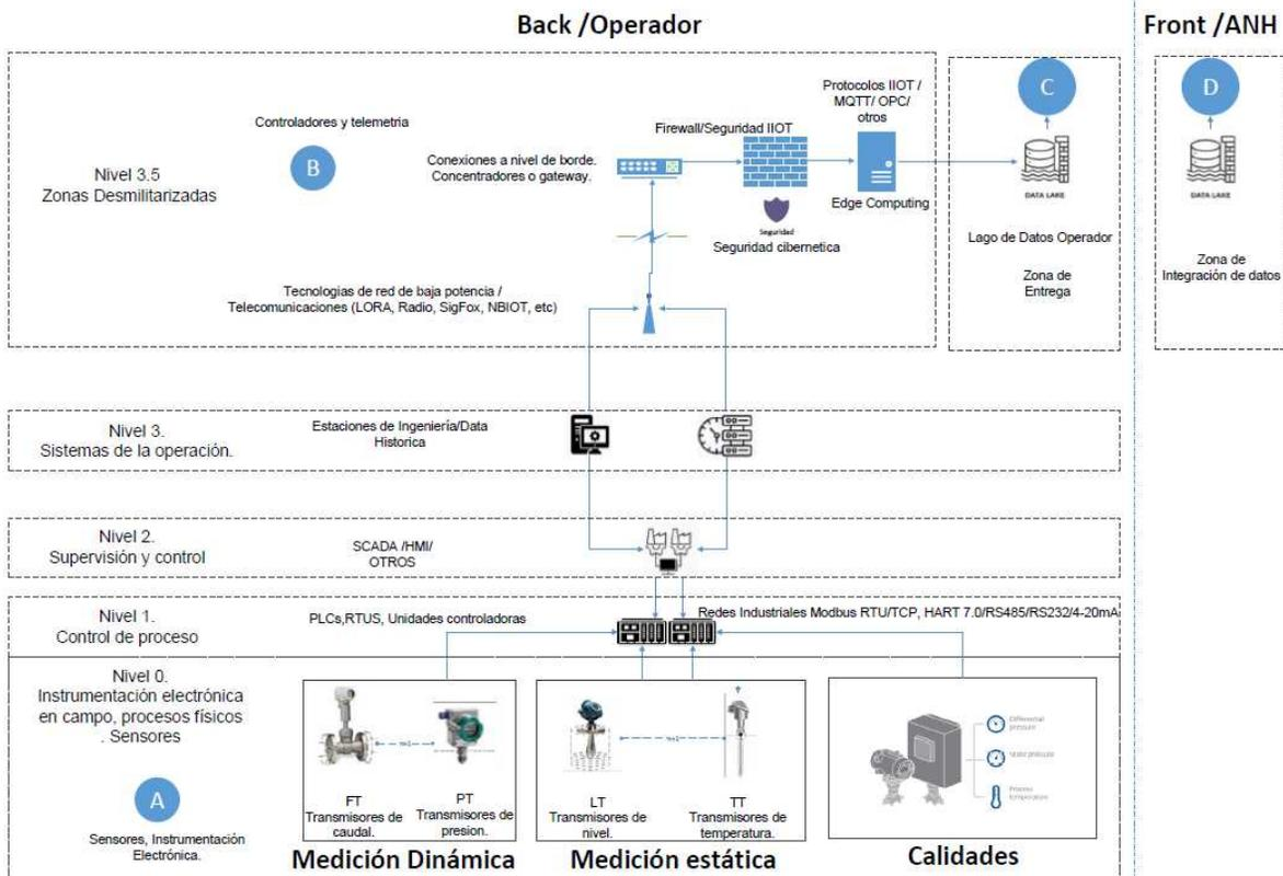
**Figura 5. Filosofía a nivel de arquitectura Back (Alta Frecuencia) - LPWAN, Requerimientos de transmisión. – Fuente. ANH**
